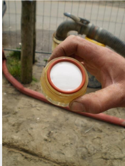
Meting slibhoudendheid met een filterspuit.
